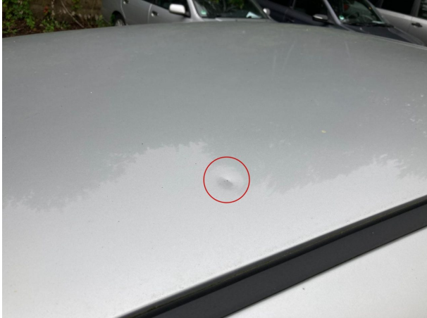
Beschädigung #1: Fahrzeugdach: Dach - Delle(n) - Smart Repair
